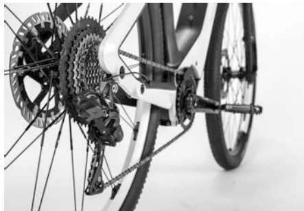
Abb. 18: Kette auf Kettenblatt / Kassette
