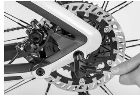
Abb. 54: Montage Achssystem Hinterrad
