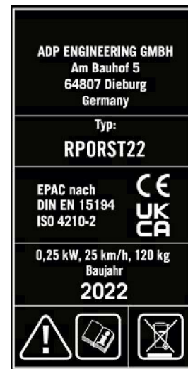
Abb. 1: Typenschild beispielhaft für PORSCHE EPACs
