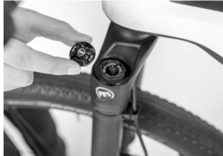
Abb. 43: Druckventil für Gabeldruckeinstellung
