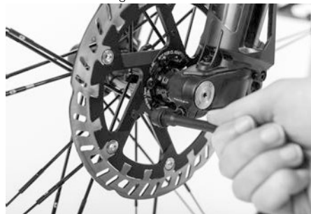
Abb. 52: Verstauen des Pannenwerkzeugs
