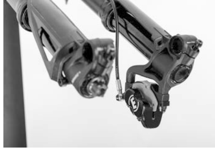
Abb. 64: Transportsicherung der Scheibenbremse
