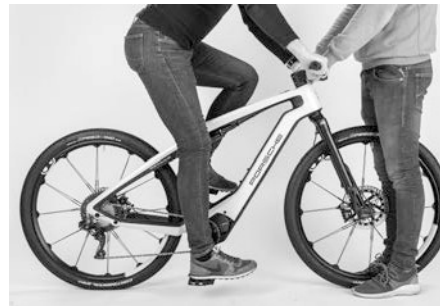
Abb. 38: Ermittlung der richtigen Sattelhöhe
