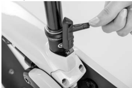
Abb. 11: Keilverschraubung Sattelstütze prüfen
