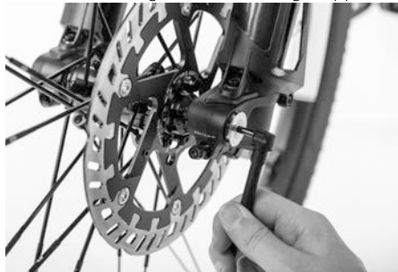
Abb. 50: Montage der Sicherungskappe
