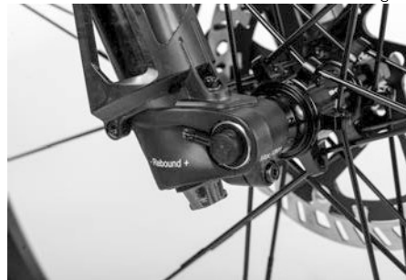
Abb. 52: Verstauen des Pannenwerkzeugs
