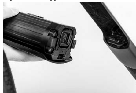
Fig. 32: Montaggio della batteria di trazione
