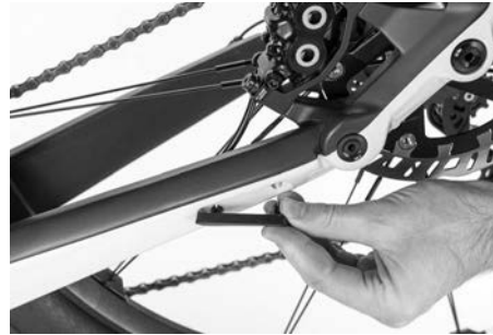
Fig. 56: Copertura del cavalletto
