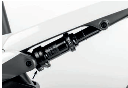
Fig. 47: Ajuste de la amortiguación
