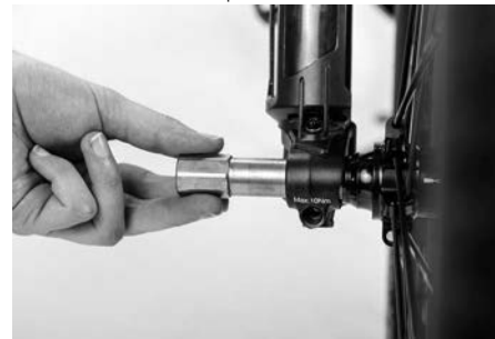
Fig. 49: Montaje del sistema del eje delantero de la Sport
