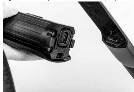
Fig. 32: Montaje de la batería de propulsión
