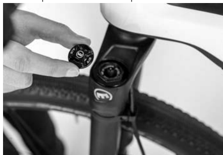
Fig. 43: Válvula de presión para ajustar la presión de la horquilla
