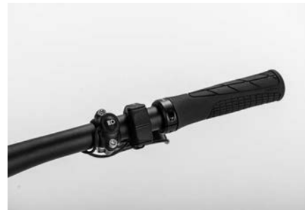
Fig. 24: Posición de la maneta de cambio (electrónica)
