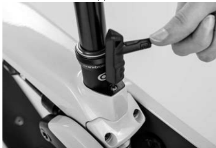
Fig. 42: Unión roscada de la chaveta / Tija de sillín Dropper
