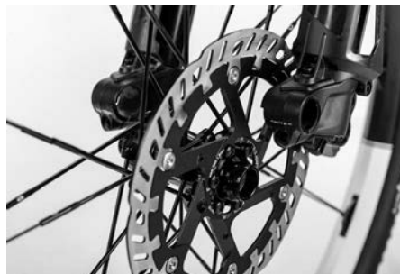
Fig. 48: Montar la unión roscada del eje / rueda delantera
