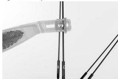
Fig. 60: Montaje de los reflectores laterales
