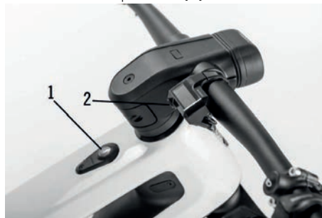
Fig. 5: Tecla de encendido / apagado (1) y tecla de pantalla (2)
