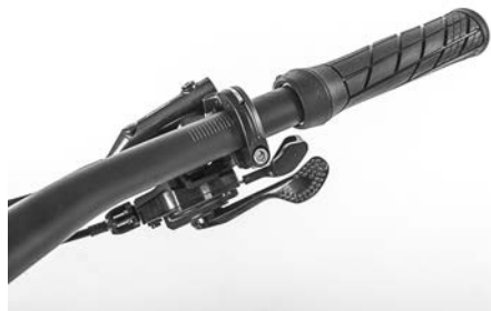
Fig. 23: Posición del mando del cambio (mecánico)
