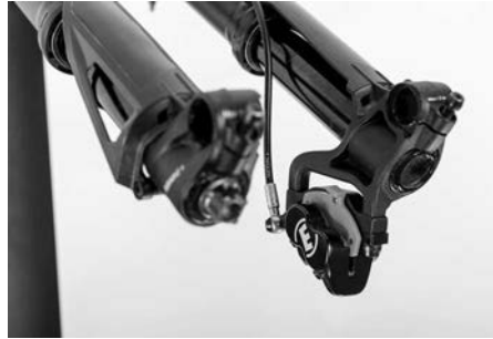
Fig. 64: Fijación de transporte de los frenos de disco
