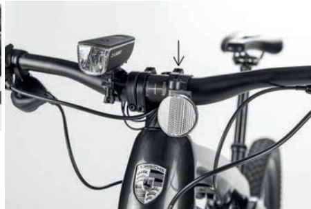
Fig. 62: Montaje del reflector frontal
